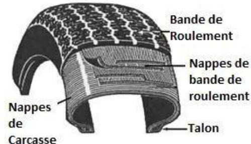
L'une des innovations du pneu radial est qu'on y distingue très facilement la spécialisation des fonctions flanc et sommet. Les flancs sont constitués d'une seule nappe textile. Ils ne sont donc plus affectés par les phénomènes de cisaillement observés sur le pneu diagonal. La nappe textile, comme la couche de caoutchouc qui l'englobe, est mince et donc flexible. La grande souplesse des flancs génère confort et économie d'énergie.
