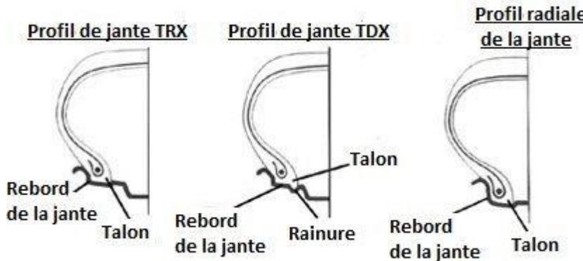
Michelin a également conçu la jante TDX qui tout comme la TRX, ne peut que chauffer les pneus dédiés TDX. Les bords des jantes TDX ont deux cannelures suivant la circonférence. Les talons du pneu sont spécialement rallongés pour leur permettre de se longer parfaitement dans les
