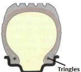
Succédant au pneu à talon, le pneu conventionnel à tringles constitue la deuxième génération de pneu démontable. L'intégration de tringles dans les bourrelets, en 1925, permet d'améliorer le maintien du pneu sur la jante. Ces pneus bénéficient également de deux innovations antérieures à leur création: l'introduction du noir de carbone dès 1917 qui multiplie par cinq la longévité des pneus et l'apparition, dans la carcasse
